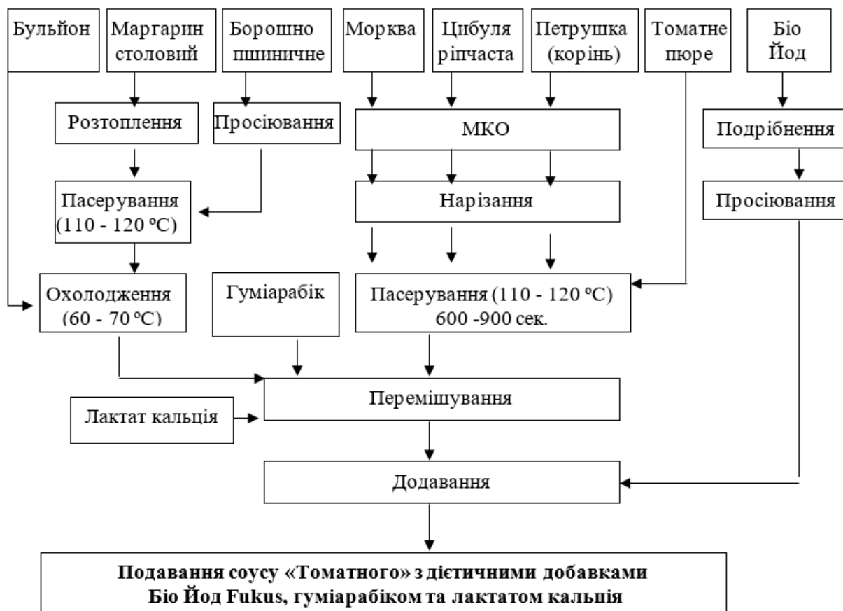
Рисунок 1 – Технологічна схема виготовлення соусу «Томатного» з використанням дієтичних добавок
