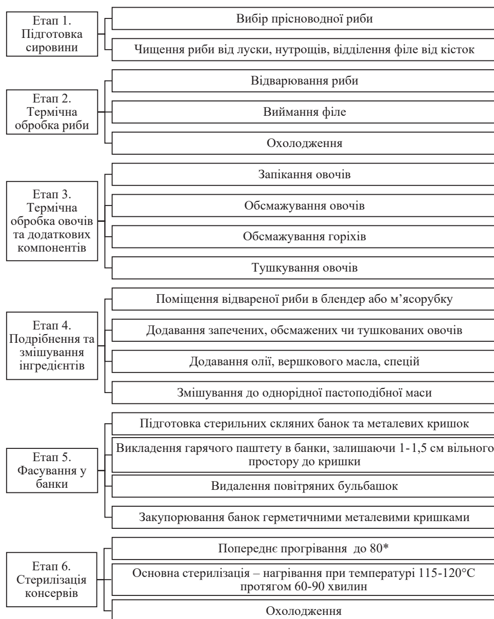
Рисунок 1 – Технологічний процес приготування рибних паштетів з прісноводної риби з додаванням рослинних наповнювачів
